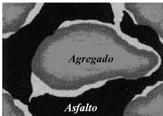
Figura 2.10. Desprendimiento del ligante del agregado por efecto de la humedad. 2
