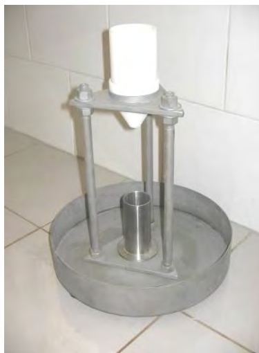
Figura 2.12. Equipo de ensayo para angularidad según norma ASTM C 1252.
