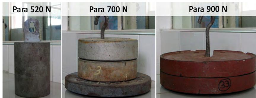
Figura 3.21. Pesos de las diferentes configuraciones de carga.
