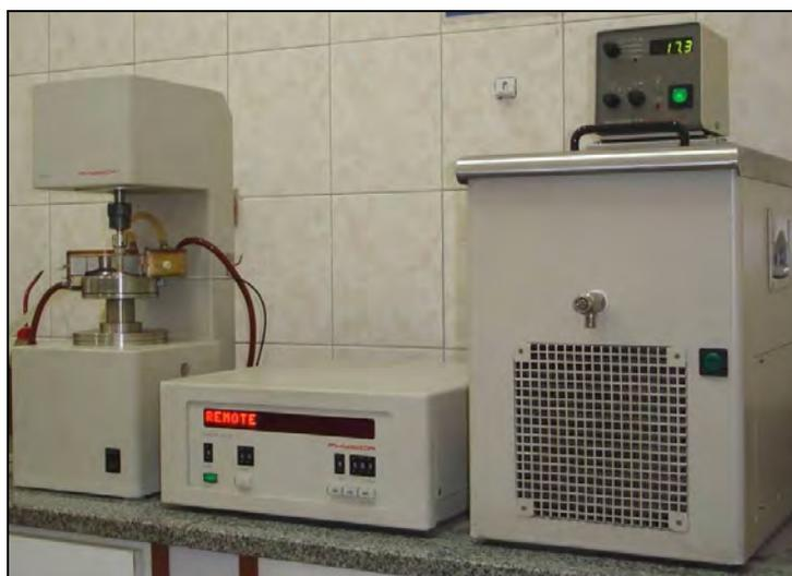
Figura 3.9. Reómetro de Corte Dinámico (DSR).
