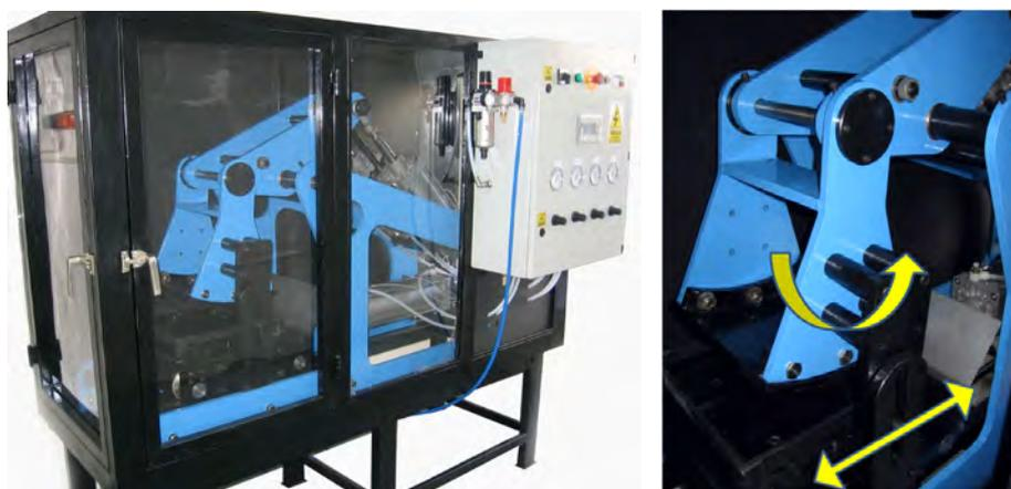
Figura 3.16. Equipo compactador de placa.
