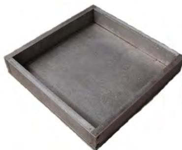
Figura 3.17. Molde para probetas de ensayo de rueda cargada.
