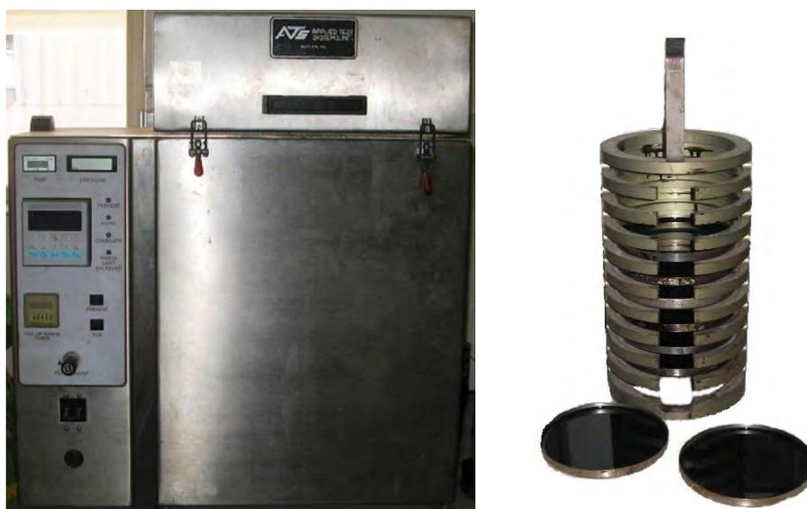
Figura 3.8. Equipo PAV. Vista general (Izquierda). Bandejas y bastidor (Derecha).
