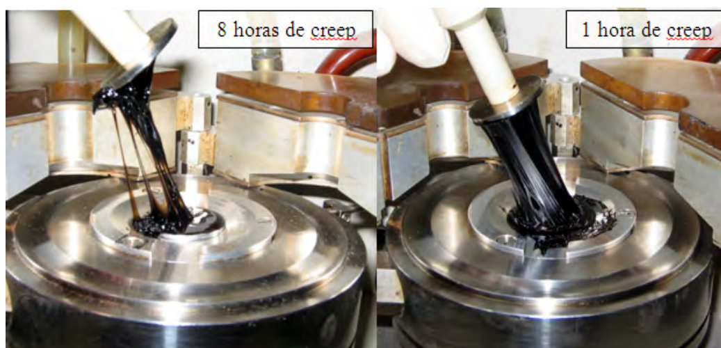
Figura 4.10. Detalle de dos muestras de asfalto MP2 luego de estar sometidas a diferentes tiempos en el ensayo de creep.
