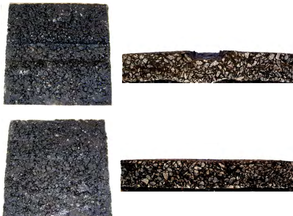
Figura 6.5. Aspecto de diferentes muestras después del ensayo de rueda cargada. Mezcla M-10 C3 (Arriba), mezcla SMA-10 MP3 (Abajo).
