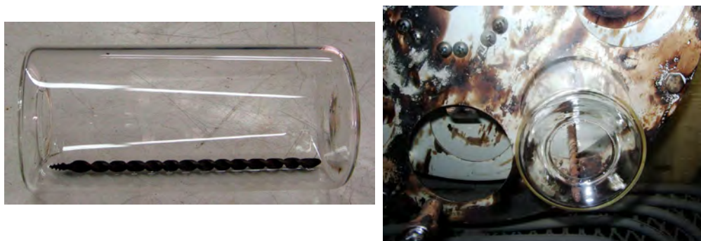
Figura 6.1. Varilla helicoidal dentro del recipiente de vidrio del RTFOT.
