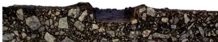
Figura 6.16. Fotos de probetas ensayadas bajo diferentes niveles de carga.
