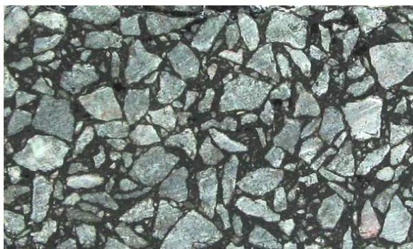
Figura 2.6. Mezcla tipo microaglomerado.
