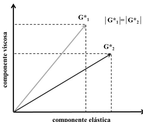
Figura 2.17. Importancia del  $\delta$  en el trabajo disipado.
