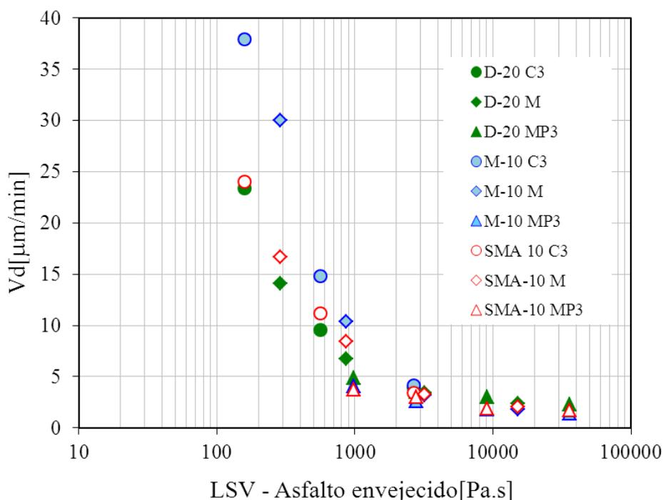
Figura 6.10. Vd versus LSV del asfalto envejecido.
