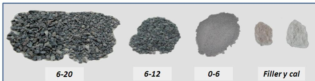
Figura 3.1. Agregados utilizados.
