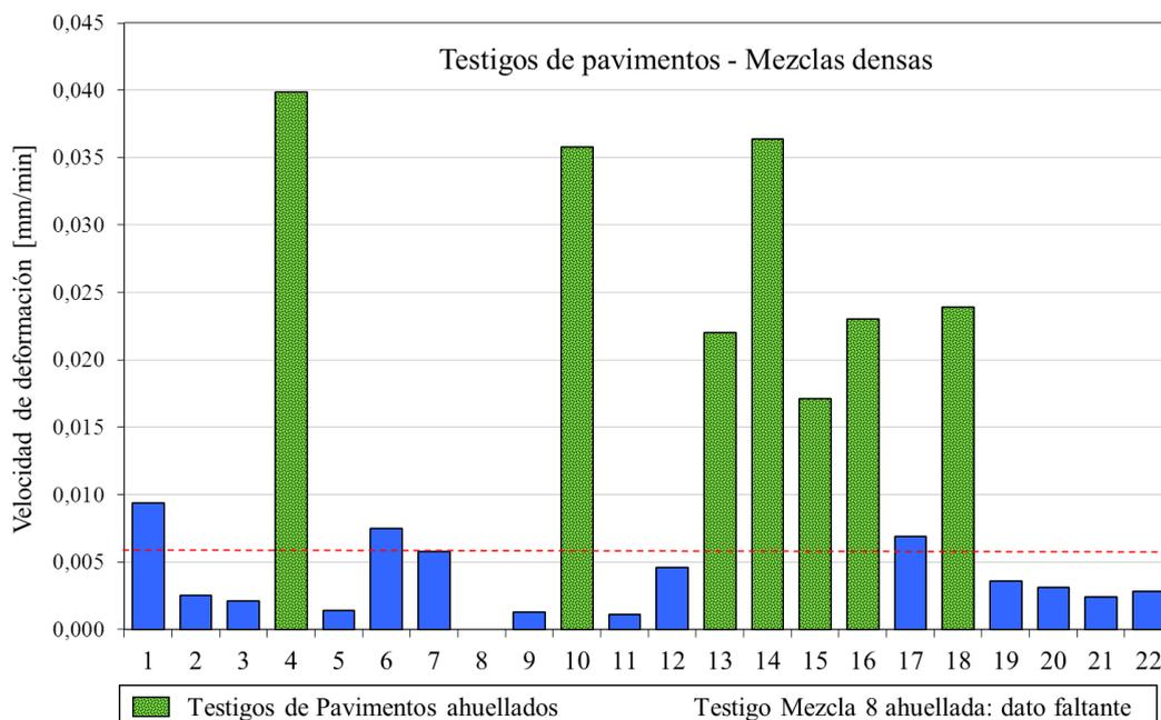
Figura 2.31. Resultados de velocidad de deformación de testigos de pavimentos ensayados en el equipo de rueda cargada.
