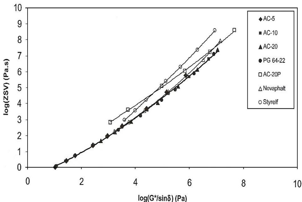
Figura 2.30. Relación de la ZSV con  $G^*/\text{sen}\delta$  de diferentes ligantes a diferentes temperaturas.<sup>6</sup>
