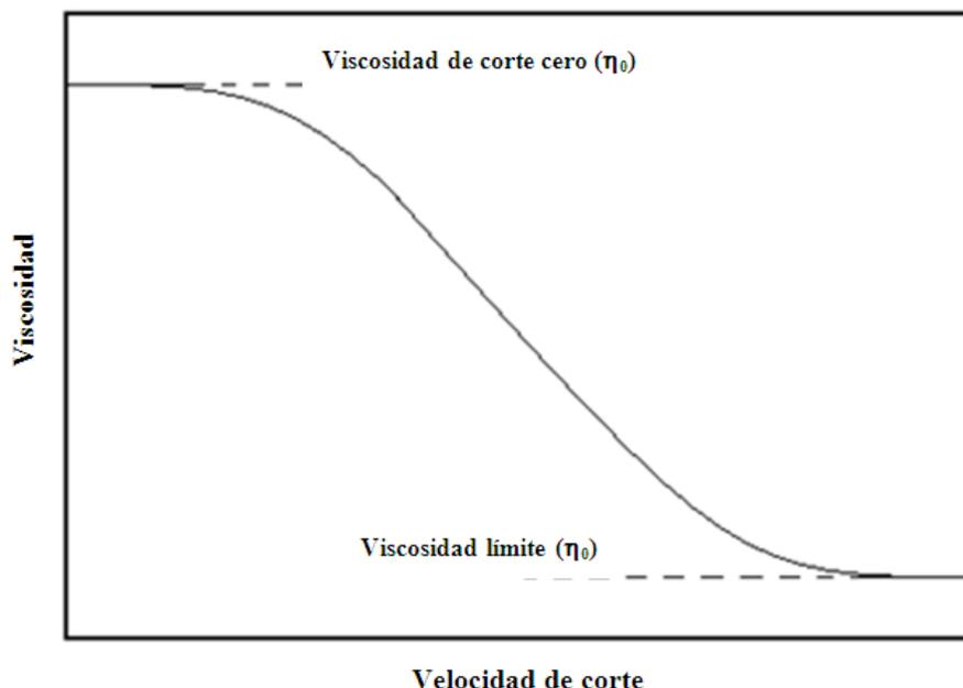
Figura 2.21. Viscosidad en función de la frecuencia.
