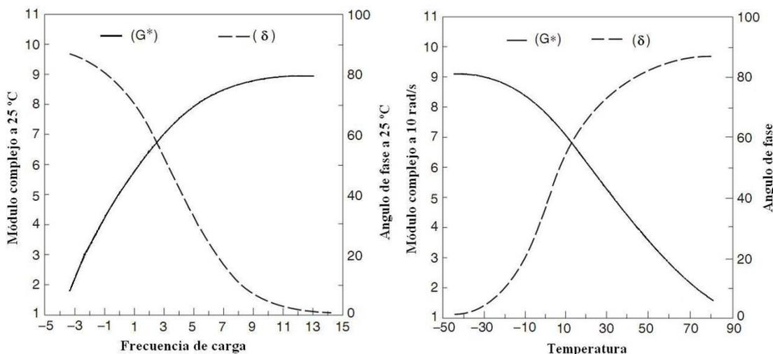
Figura 2.16. Módulo dinámico ( $G^*$ ) y ángulo de fase ( $\delta$ ) en función de la frecuencia de carga (izquierda) y en función de la temperatura (derecha).
