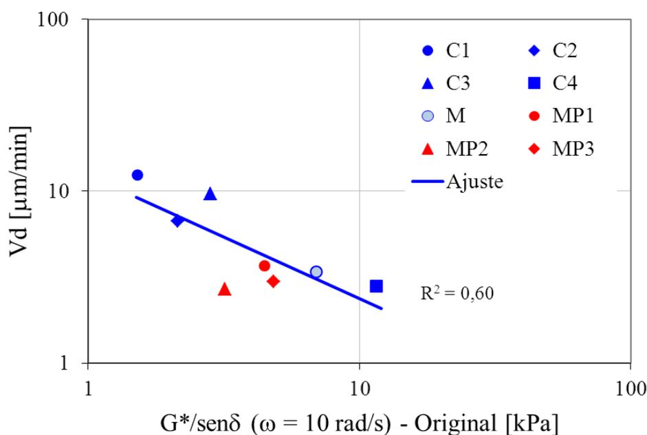
Figura 5.1.  $V_d$  en función del  $G^*/\text{sen}\delta$  ( $\omega = 10\text{rad/s}$ ) en asfalto original.
