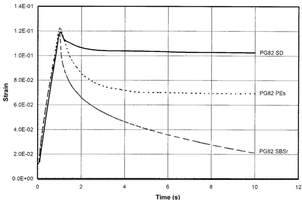
Figura 2.28. Deformaciones en el tiempo en ensayo de multicreep de varios asfaltos para el ciclo de carga N° 100.<sup>5</sup>
