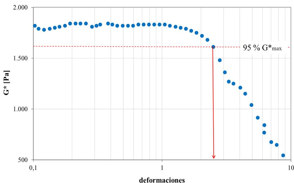
Figura 3.13. Módulo complejo ( $G^*$ ) versus deformaciones.
