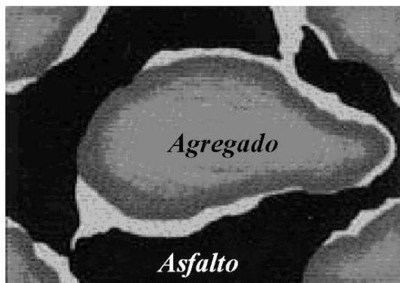
Figura 2.10. Desprendimiento del ligante del agregado por efecto de la humedad.<sup>2</sup>
