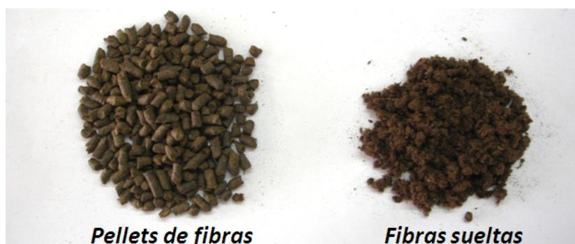
Figura 3.2. Fibras utilizadas en la SMA.
