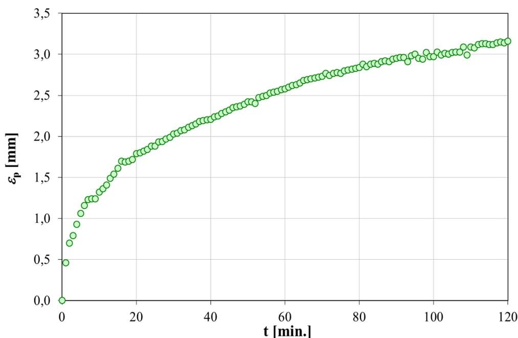
Figura 3.20. Curva típica de deformaciones permanentes en función del tiempo obtenida en un ensayo de rueda cargada.
