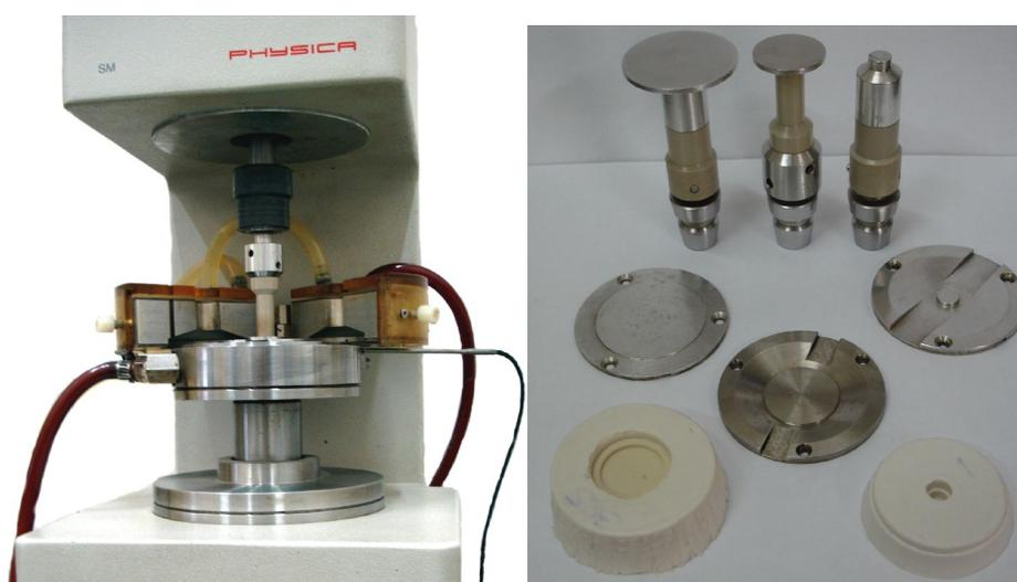
Figura 3.10. Vista del plato de carga con cabezales de calentamiento (izquierda). Diferentes accesorios del equipo (derecha).
