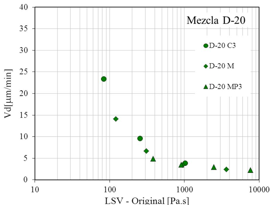
Figura 6.6.  $V_d$  de las mezclas D-20 en función de la LSV de los asfaltos.
