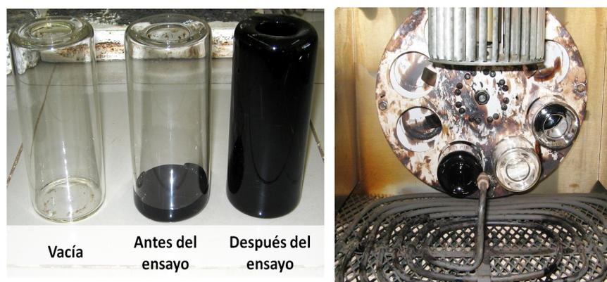
Figura 3.7. Ensayo RTFOT. Recipientes de ensayo (Izquierda), Vista interior (Derecha).
