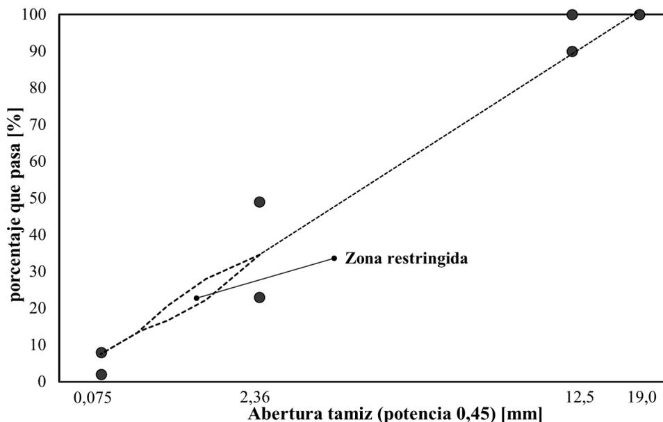
Figura 2.9. Huso granulométrico Superpave con zona restringida.
