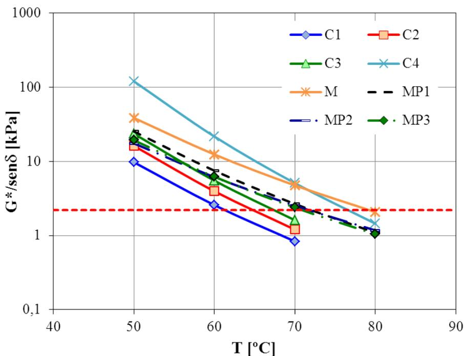
Figura 4.2.  $G^*/\text{sen}\delta$  vs  $T - \omega_1 = 10$  rad/s. Asfaltos envejecidos en RTFOT.
