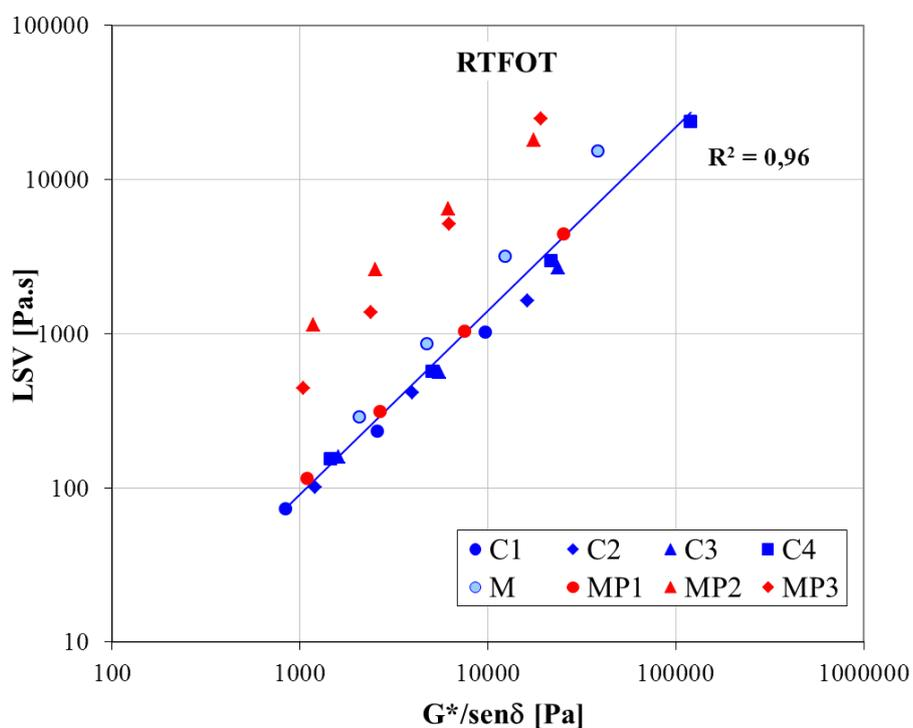
Figura 4.12. LSV versus  $G^*/\text{sen}\delta$  ( $\omega = 10$  rad/s). Asfaltos envejecidos.
