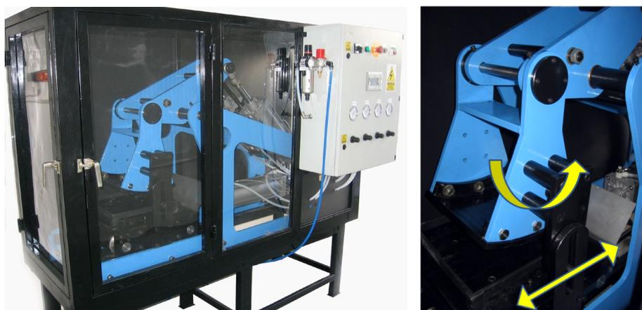
Figura 3.16. Equipo compactador de placa.
