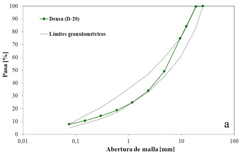
Figura 3.3. Gradación de la mezcla densa (D-20).
