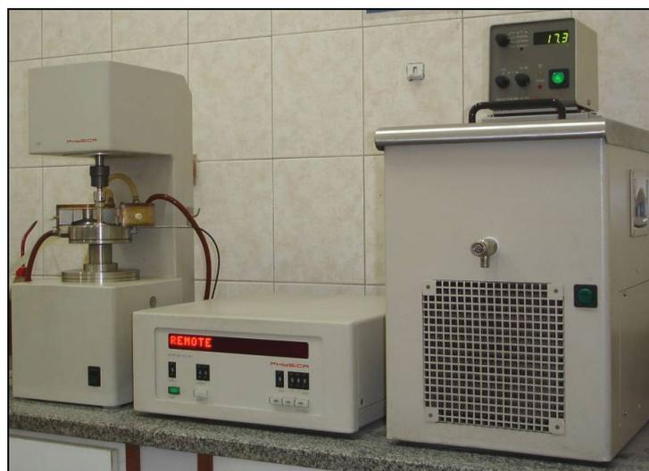
Figura 3.9. Reómetro de Corte Dinámico (DSR).
