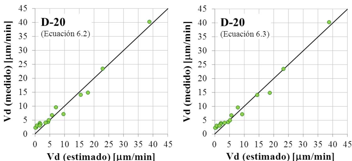
Figura 6.21.  $V_d$  del ensayo mezcla D-20 versus  $V_d$  estimadas.
