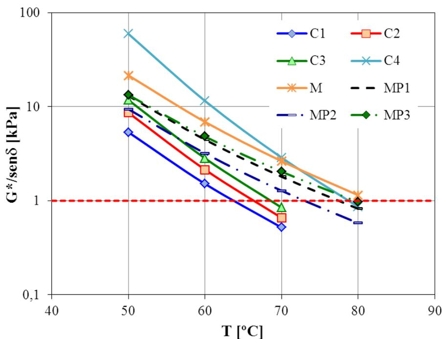
Figura 4.1.  $G^*/\text{sen}\delta$  vs  $T - \omega_1 = 10$  rad/s. Asfaltos en estado original.
