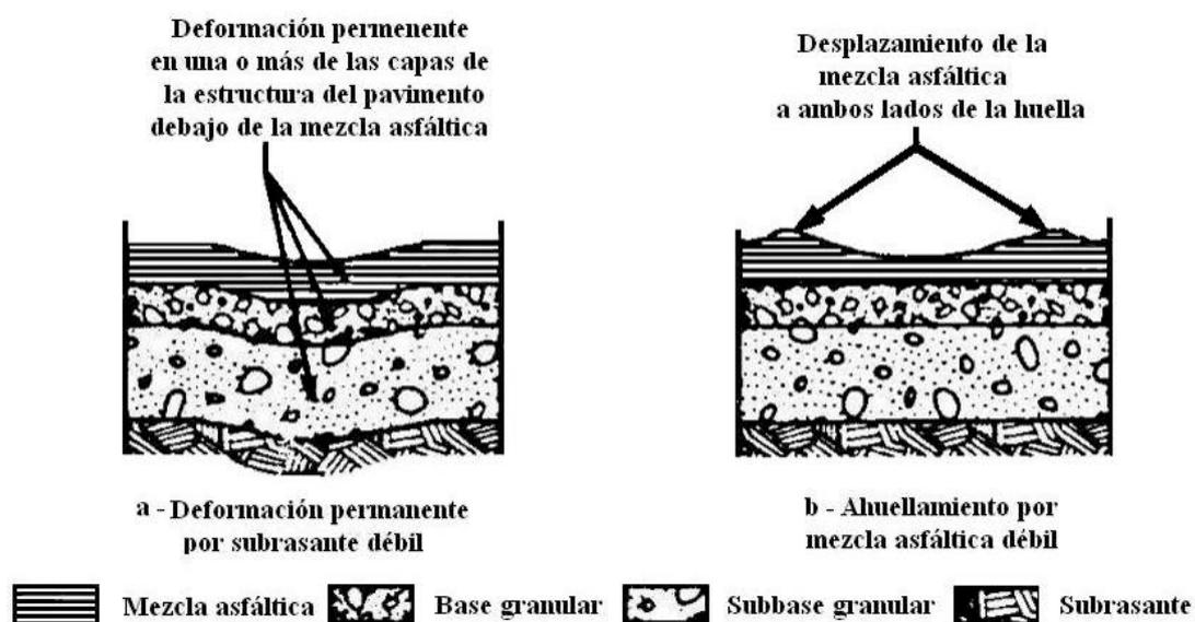
Figura 2.3. Tipos de ahuellamientos.<sup>1</sup>
