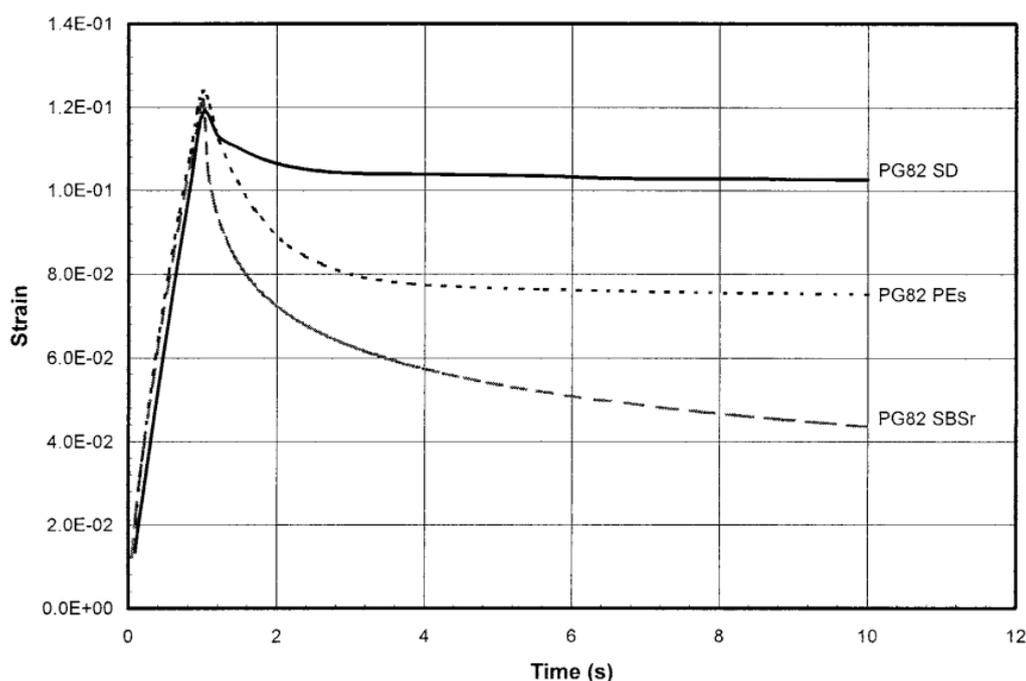
Figura 2.27. Deformaciones en el tiempo en ensayo de multicreep de varios asfaltos para el primer ciclo de carga.<sup>4</sup>
