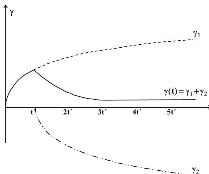
Figura 2.25. Ensayo de creep incompleto.
