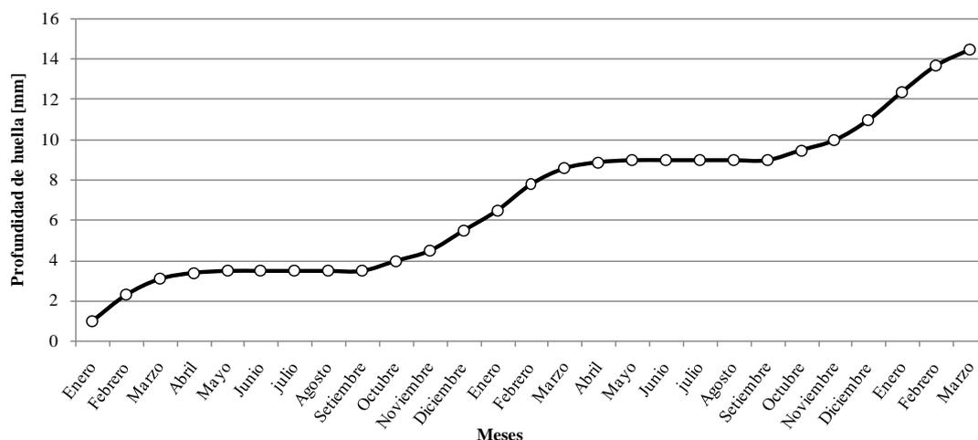
Figura 2.5. Acumulación de deformaciones permanentes en sucesivos veranos.
