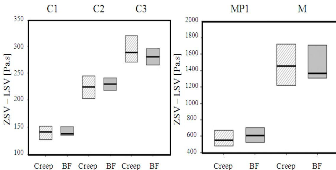
Figura 4.6. Análisis comparativo de los resultados de los ensayos de Creep y Barrido de frecuencias (BF). Izquierda: asfaltos convencionales; derecha: asfaltos modificados.
