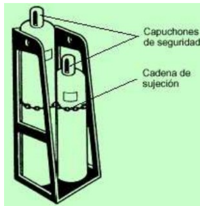
Figura 6. Plataforma para desplazamiento de tubos con gases. Fuente: Nota técnica de Prevención (NTP) nº495 del Instituto Nacional de Seguridad y Salud en el Trabajo de España
