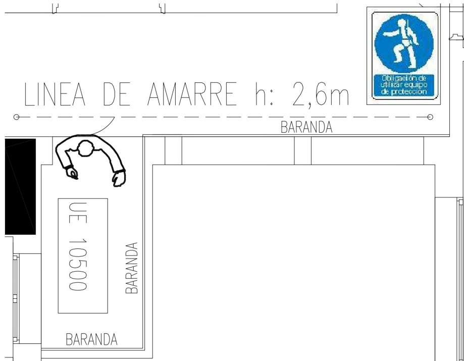
Figura 14. Instalación unidad exterior AA.
