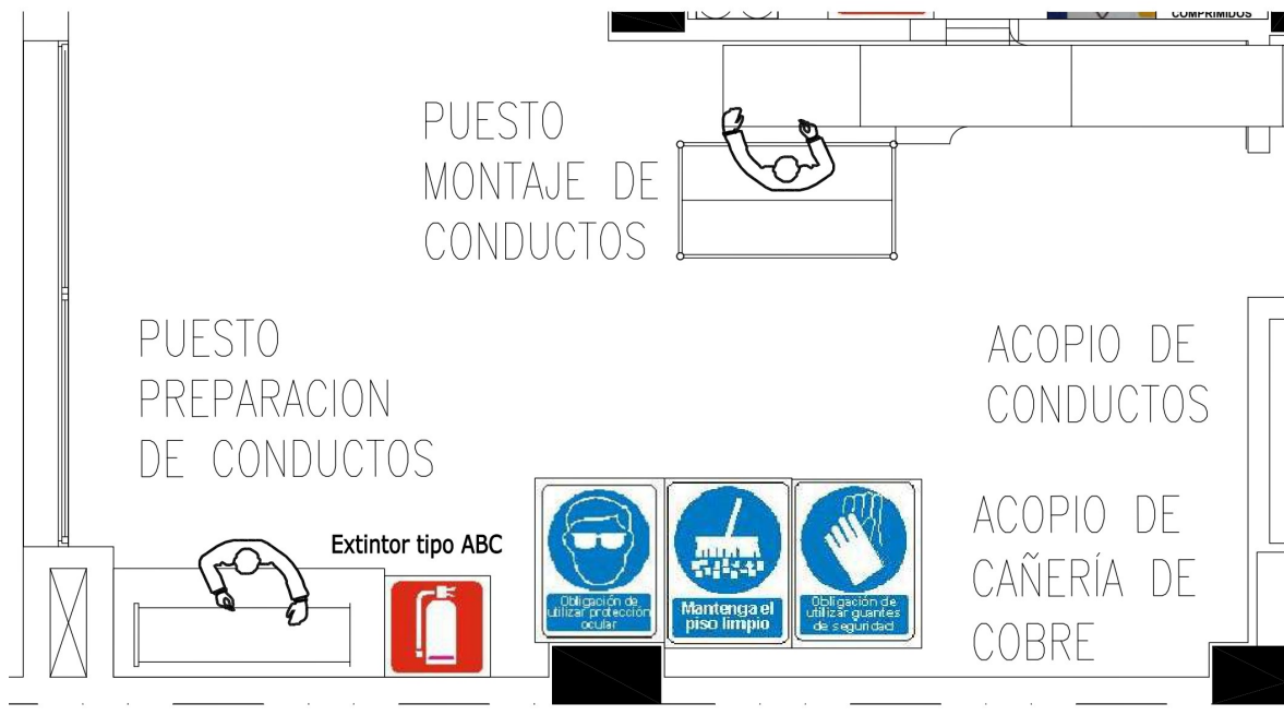
Figura 12. Puesto de trabajo: preparación, ajustes, realización de agujeros para derivaciones, aislación de conductos de chapa galvanizada.
