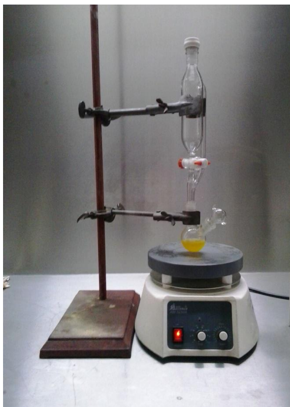
Imagen 2.3.1.b. Equipamiento empleado en la reacción llevada a cabo en la etapa 2 de la síntesis del CTA 1 .
