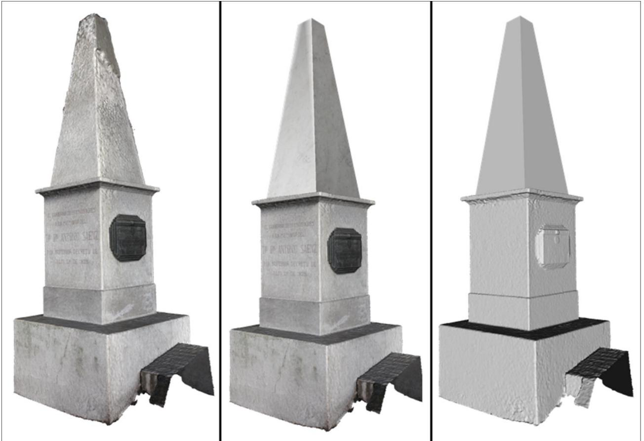
Figura 12. Izquierda: Malla 3D texturizada obtenida. Centro: Malla 3D corregida con técnicas de modelado y vuelta a texturizar. Derecha: Malla 3D final sin textura.
