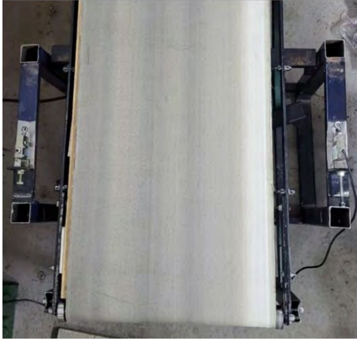
Figura 51. Posicionamiento de cinta y celdas de carga.
