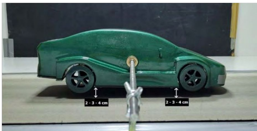
Figura 48. Modelo de serie - Suelo móvil
