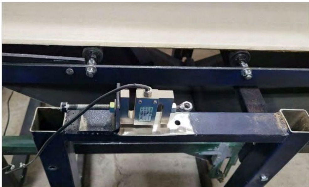
Figura 50. Montaje de celda sobre bastidor
