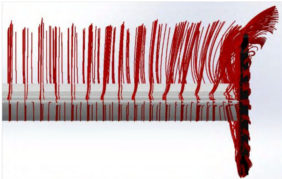
Figura 29. Flujo sobre alerón con endplates – Vista frontal
