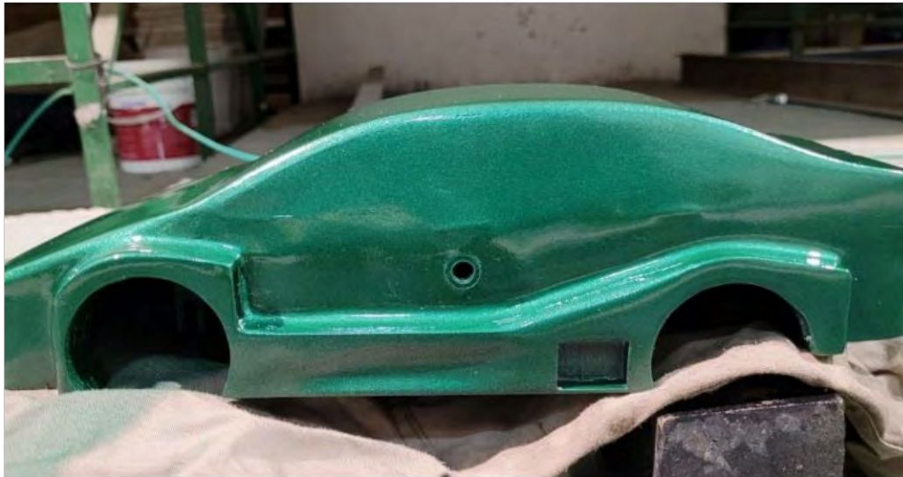
Figura 69. Aplicación de pintura – Vista lateral
