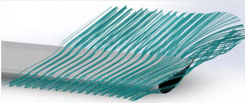
Figura 26. Simulación de flujo sobre perfil superior
