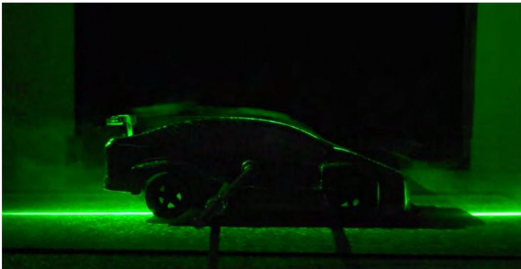
Figura 79. Estela turbulenta con utilización de cinta móvil
