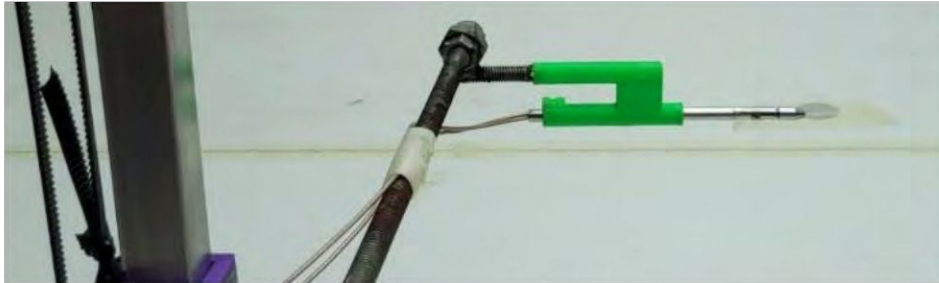
Figura 56. Soporte de sensor de hilo caliente
