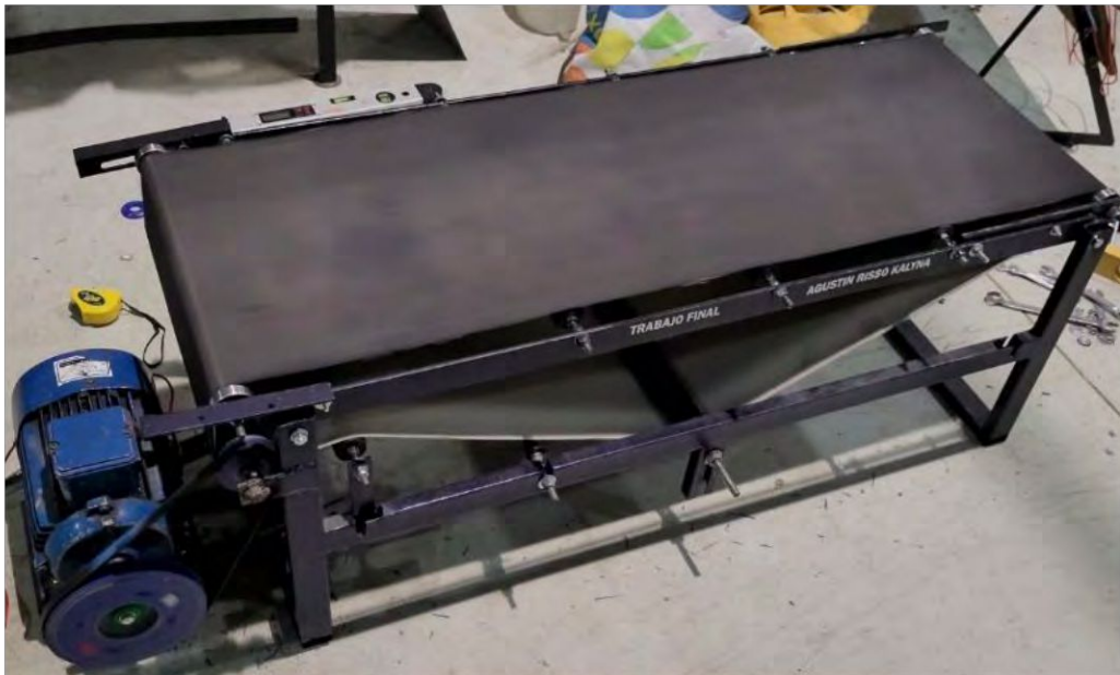
Figura 73. Acople de motor trifásico mediante correa dentada
