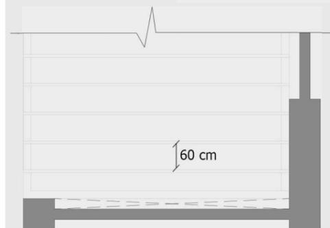
EN EL INTERIOR DE LA TORRE SE GENERAN GRANDES ALTURAS, DONDE MEDIANTE ENTREPISOS METÁLICOS SE CONSTRUYEN LOS NIVELES PARA HOSTEL Y HOTEL. ASI MAXIMIZAR EL RENDIMIENTO EN M<sup>2</sup>. EN LOS INTERSTICIOS QUE SE GENERAN ENTRE LAS NUEVAS ESTRUCTURAS Y LAS EXISTENTES SE UBICAN LOS PLENOS NECESARIOS PARA LAS INSTALACIONES DE LA TORRE
