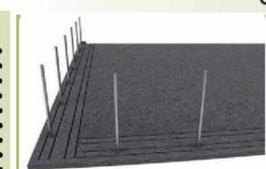
LA VINCULACIÓN DE LA ESTRUCTURA DE HºAº CON LOS PANELES SE REALIZA A TRAVÉS DE HIERROS Ø6 QUE SE DEJAN SOBRESALIDOS 30CM DE LA ESTRUCTURA. ESTOS SE SEPARAN 30CM UNOS DE OTROS Y SOSTIENEN A LOS PANELES DE UN SÓLO LADO.
