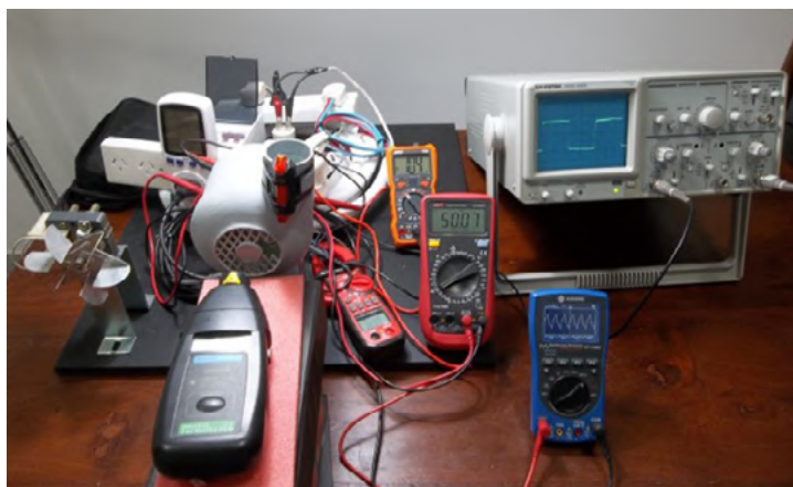
Figura 3 y 4. A la derecha, imagen del software CFturbo 2020 R2.0, modelado 3D del eje Z. A la izquierda, banco de pruebas conectado al motor extractor/soplador centrífugo de aire viciado de SARS-CoV-2 o covid-19 (coronavirus) con multimetro digital (medidor de voltios en AC), pinza amperométrica (medidor de intensidad de la corriente en AC), frecuencímetro (medidor de hercios), fotocómetro láser (medidor de velocidad en RPM), osciloscopio digital medidor de la forma de onda de la corriente alterna en tensión ( V_{pico-pico} , V_{avg} , V_{rms} ), para cálculo de factor de cresta de distorsión armónica, osciloscopio analógico para observación cualitativa de la THD (distorsión armónica de la corriente alterna), vatímetro (medidor de potencia activa en vatios o watts), factor de potencia (coseno de \phi ), power-meter (medidor del consumo de energía activa en kilowatts-hora: kWh).
