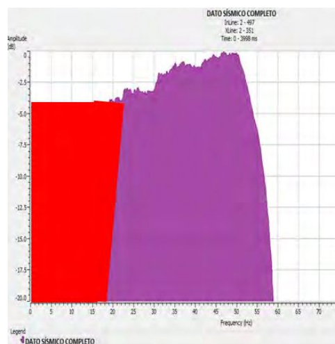
Figura 5.14: En violeta se marca el espectro de amplitud de los datos sísmicos, y en rojo se esquematiza el espectro de frecuencias que se completaría con el uso del modelo de bajas frecuencias.
