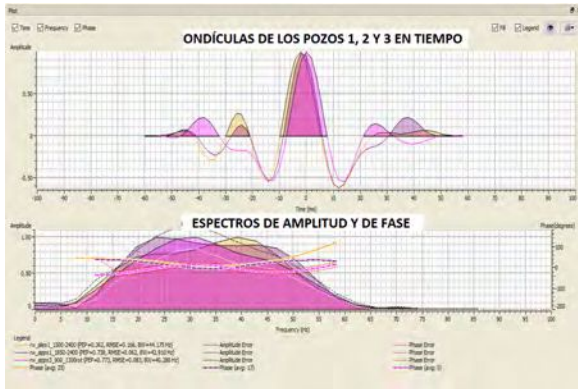
(a) Ondículas extraídas de los pozos 1, 2 y 3. Se pueden ver las ondículas en el dominio del tiempo en el panel superior y en el inferior los espectros de amplitud y fase.
