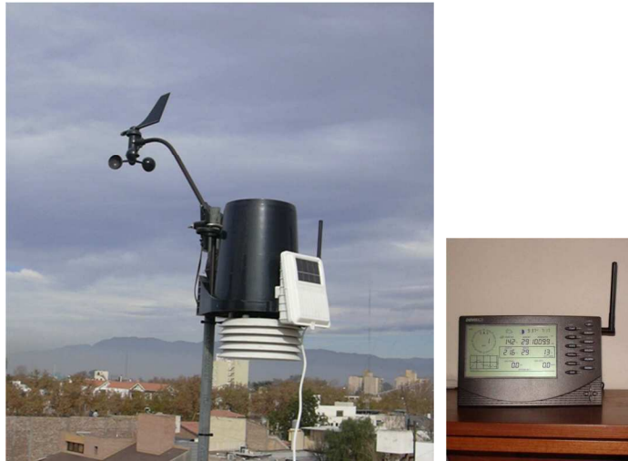
Figura 3: Estación Meteorológica (sistema de adquisición de datos y consola de registros).
