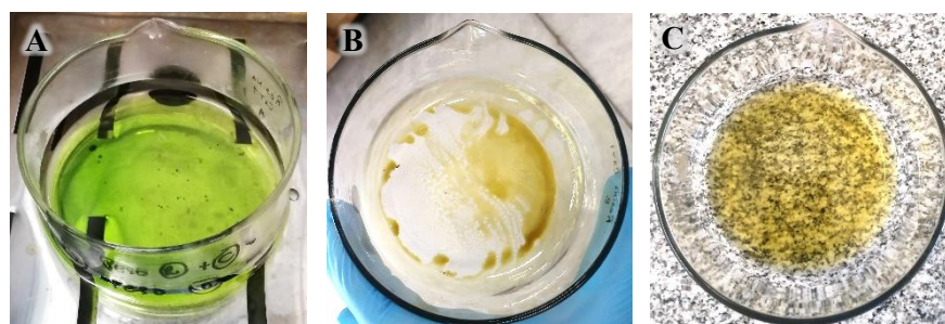
Figura 8. Obtención de aceite a partir del extracto alcohólico de CAT1. A) Evaporación del etanol dentro del baño termostático B) Resina obtenida al finalizar la evaporación C) Aceite resultante al disolver la resina en el mismo.
