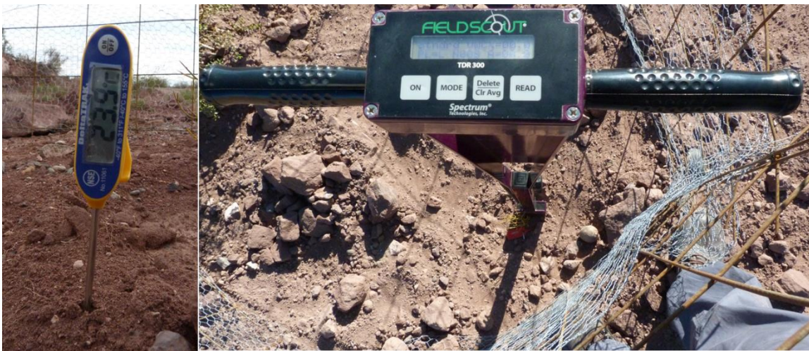
Figura 3.3: instrumentos de medición utilizados: a la izquierda, termómetro digital Delta Trak; a la derecha, TDR Fieldscout modelo 300.
