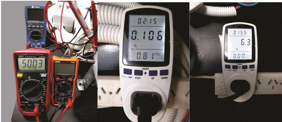
**Figuras nº 4 (a), 4 (b) y 4 (c).** A la izquierda, vista del frecuencímetro encendido indicando los 50 (Hertz) de la corriente alterna (AC), junto al multímetro digital
