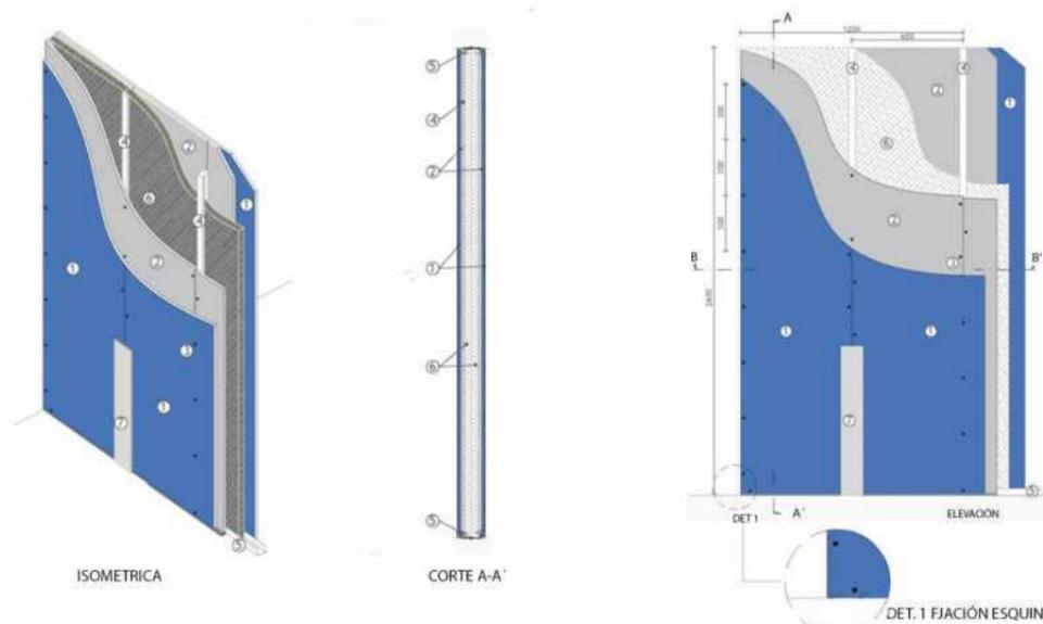
Tabique conformado por dos placas por cada lado, traslapadas entre sí. La capa interior corresponde a una placa de yeso cartón estándar (Gyplac® ST) y la capa exterior corresponde a una placa de fibrosilicato (Promatect-100X), incombustible, monolítica y estable dimensionalmente.
