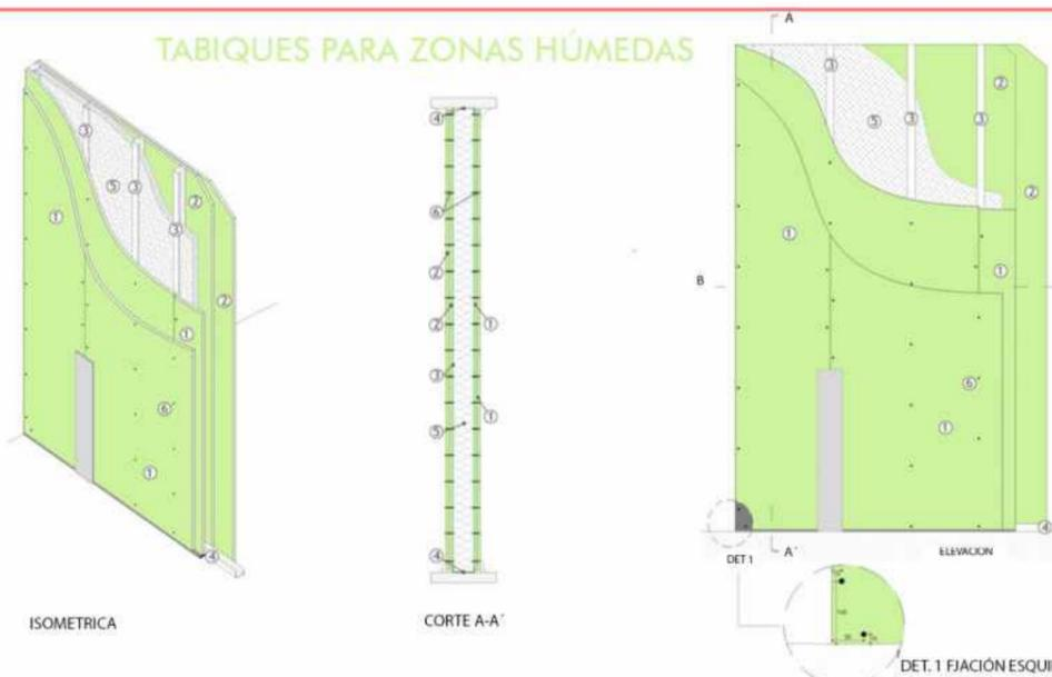
Tabique conformado por placas de yeso cartón de alta densidad Extra Resistente Hidro (Gyplac® ERH).
