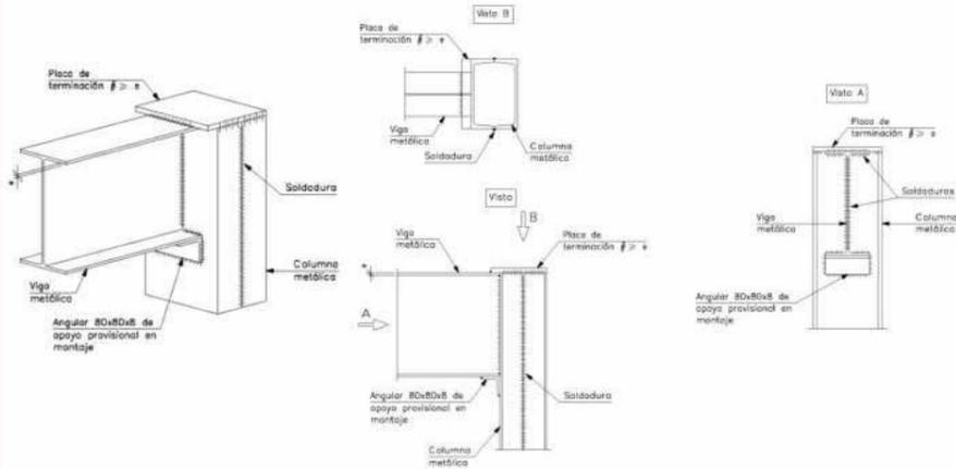
**UNIÓN DE DOS VIGAS AMBOS LADOS CON COLUMNA:**
