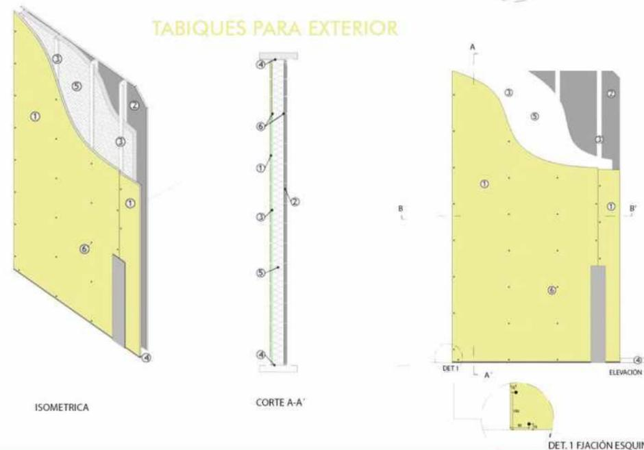
Tabique conformado por placas de yeso cartón de alta densidad Extra Resistente (Gyplac® ER) y Gyplac® AQ (Aquaboard).
