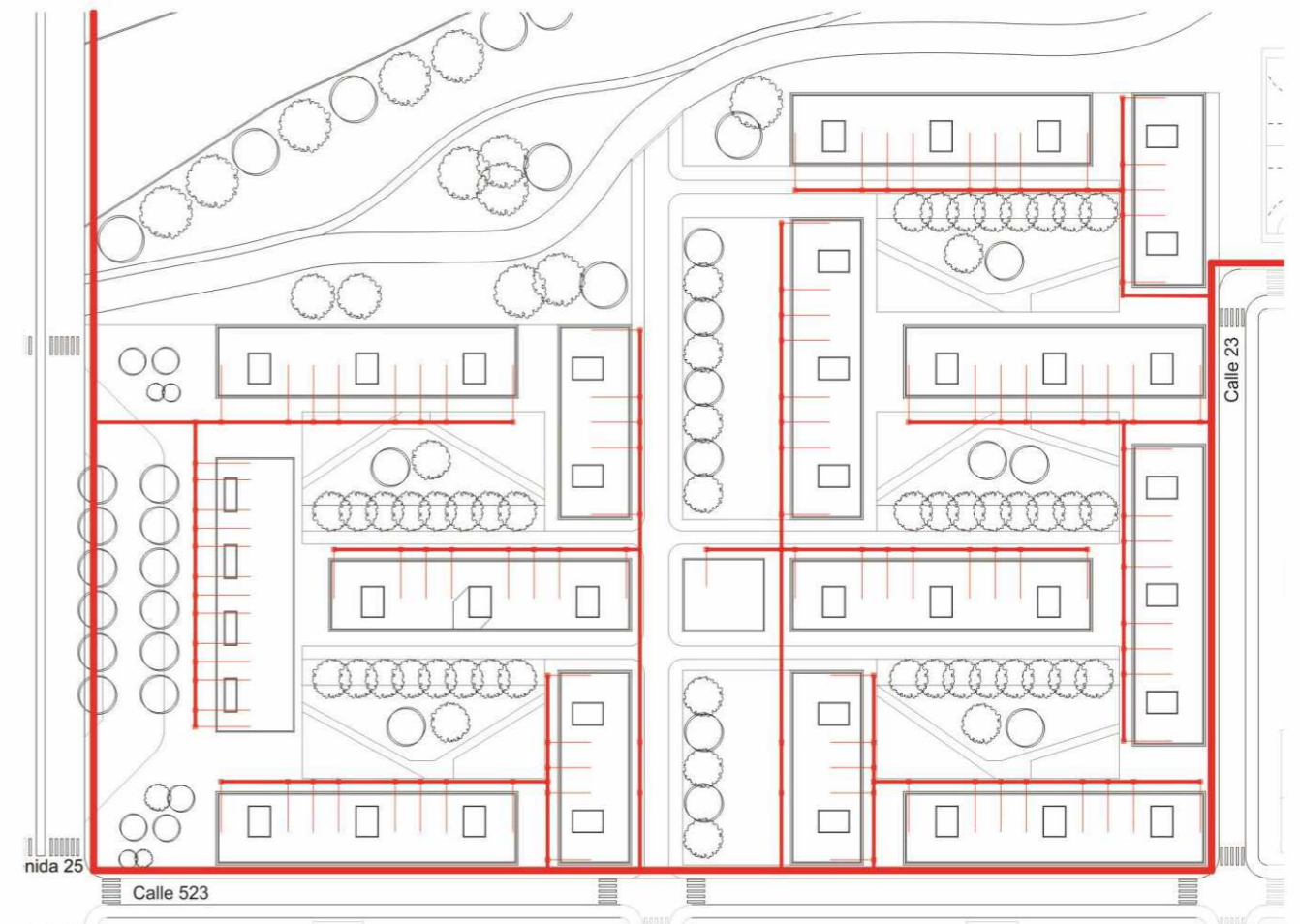
SERVICIO DE DESAGÜE CLOACAL
