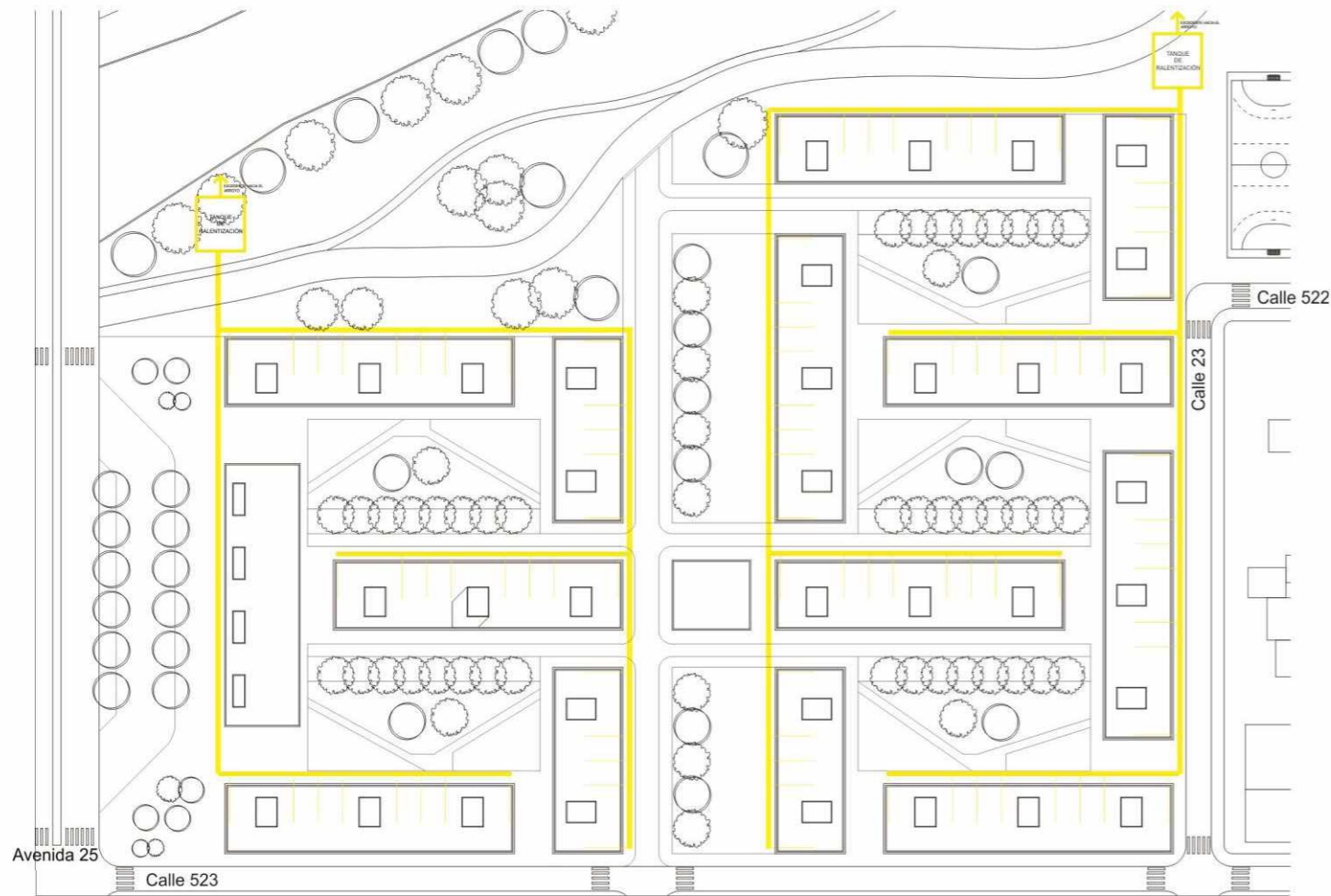
SISTEMA DE DESAGÜE PLUVIAL
