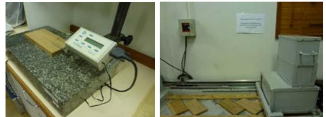
**Figura 2:** Laboratorio de Ensayos Tecnológicos de la Madera: ensayos de rugosidad/ abrasividad.
