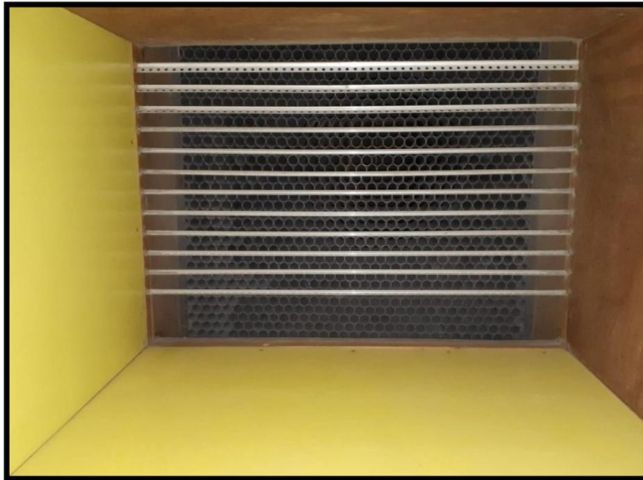
Figura 2.5 - Vista del interior del túnel donde se observan los perfiles.
