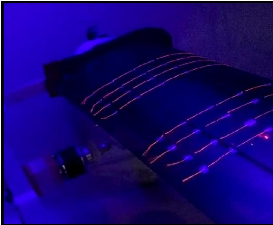
Figura 3.16 - Visualización con motor encendido, flujo adherido,  $\alpha = 17^\circ$ ,  $Re = 500000$  y  $RPM = 3000$ .
