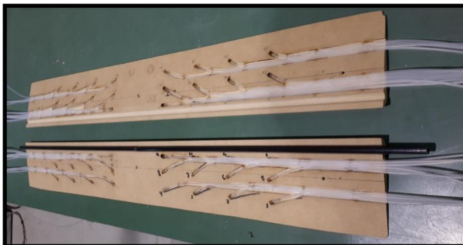
Figura 2.9 - Detalle de la instrumentación del flap.
