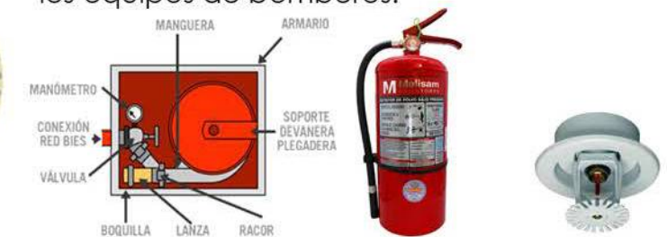
Boca de Incendio Matafuegos Rociadores Equipada
