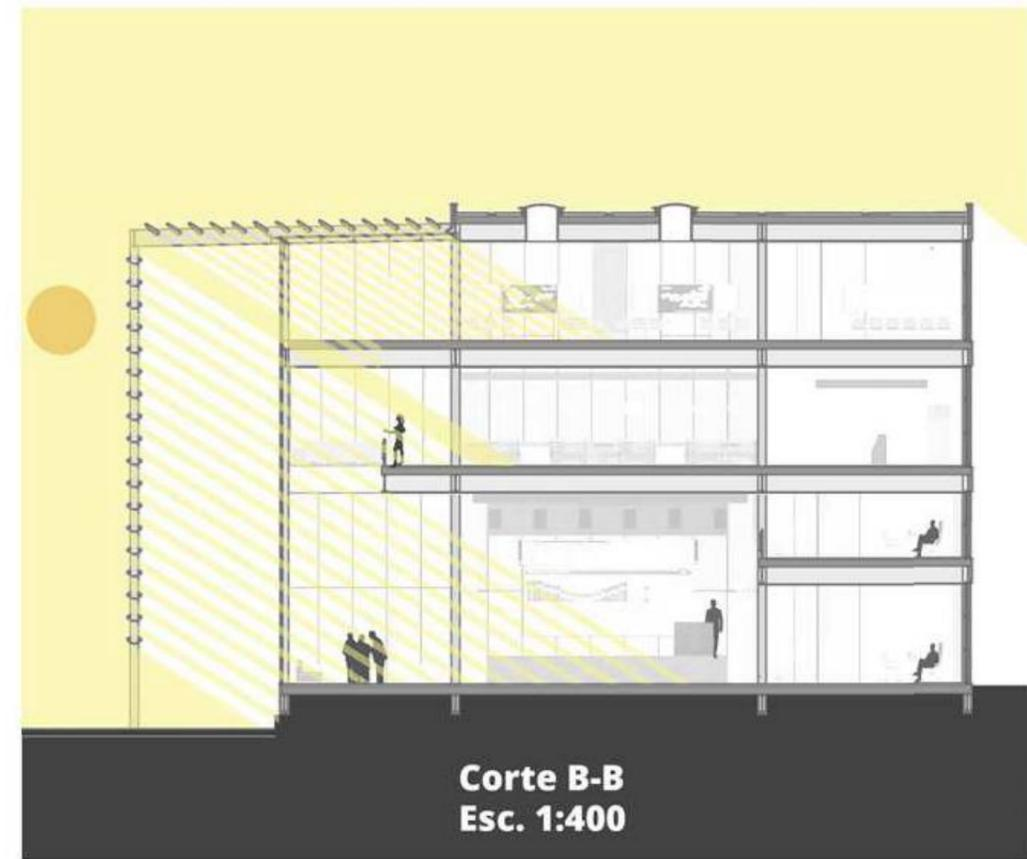
Esquema de acondicionamiento térmico pasivo en Invierno. La inclinación de los rayos solares permiten el ingreso de radiación hasta casi la mitad del edificio en las primeras horas del día, posibilitando la generación de un efecto invernadero y contener la temperatura ganada.
