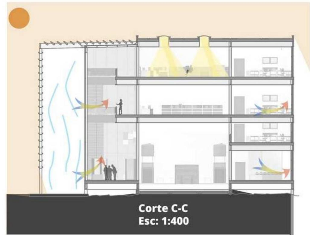
Esquema de acondicionamiento térmico pasivo en verano. La ventilación cruzada toma aire fresco del semicubierto con parasoles y plantas, distribuyendolo por el edificio.
