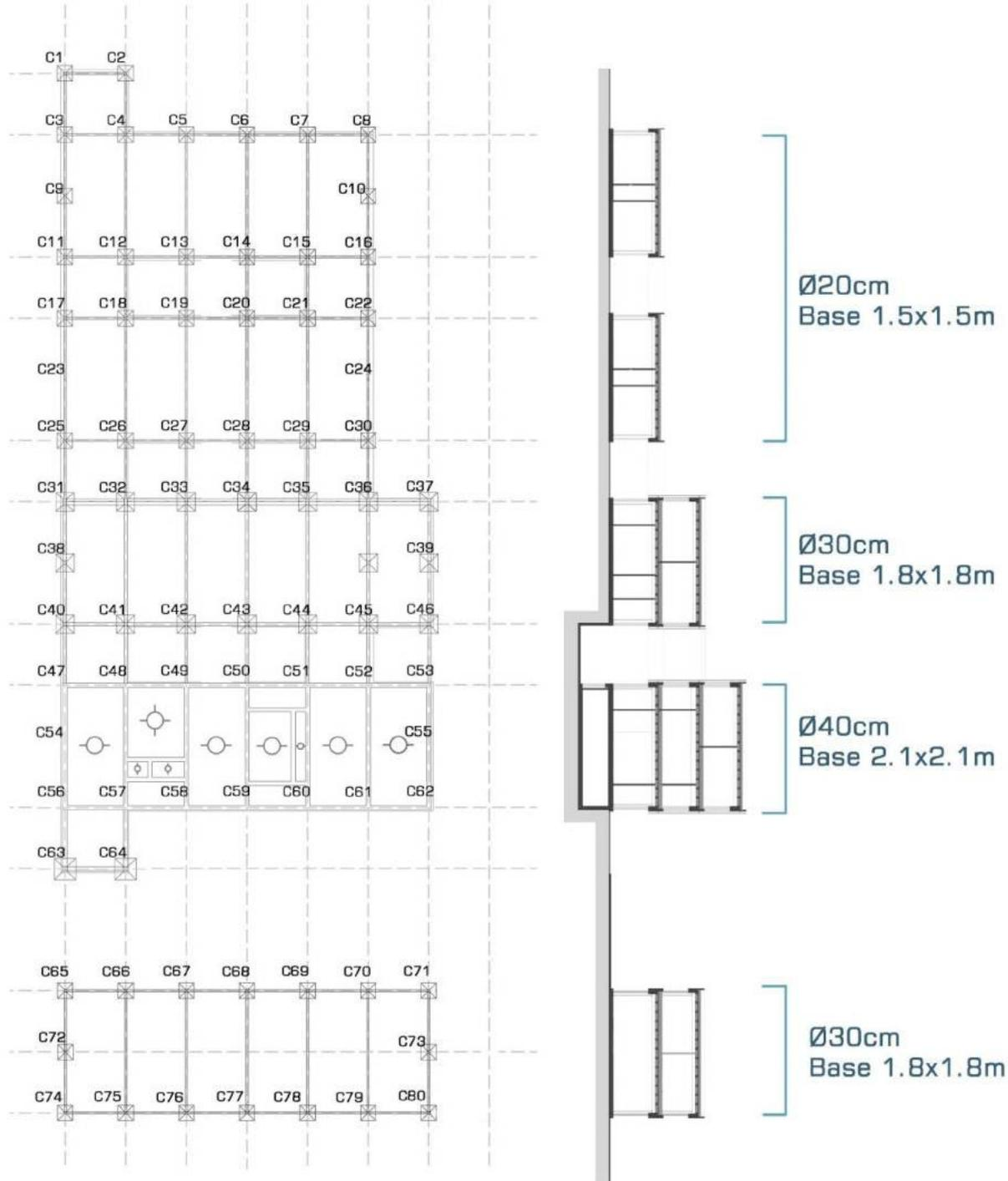
Las fundaciones se plantean de dos maneras diferentes según el sector. En un primer lugar, con **Plataea de H°A°** en los sectores de la submuración (sala de máquinas), y por otro lado, **Bases Aisladas de H°A°** para el resto del edificio.
