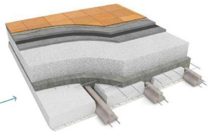
Se utiliza una **Losa Alivianada**, la cual se compone de bloques de EPS con perfiles de acero galvanizado en su interior, dos varillas de hierro en la unión entre bloques y una capa de compresión de hormigón armado. Este sistema mejora la aislación térmica, minimiza los consumos de energía, acorta los tiempos de montaje durante la obra y disminuye los costos de construcción.
