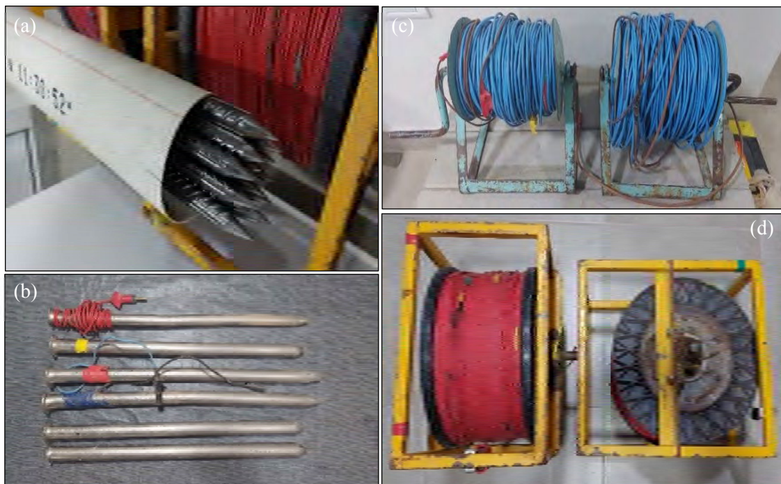
Figura 5.6. Electrodo y carretes de cables: (a) Electrodo de hierro, (b) Electrodo de acero inoxidable, (c) Carretes de 100 m y (d) Carretes de 1 km.
