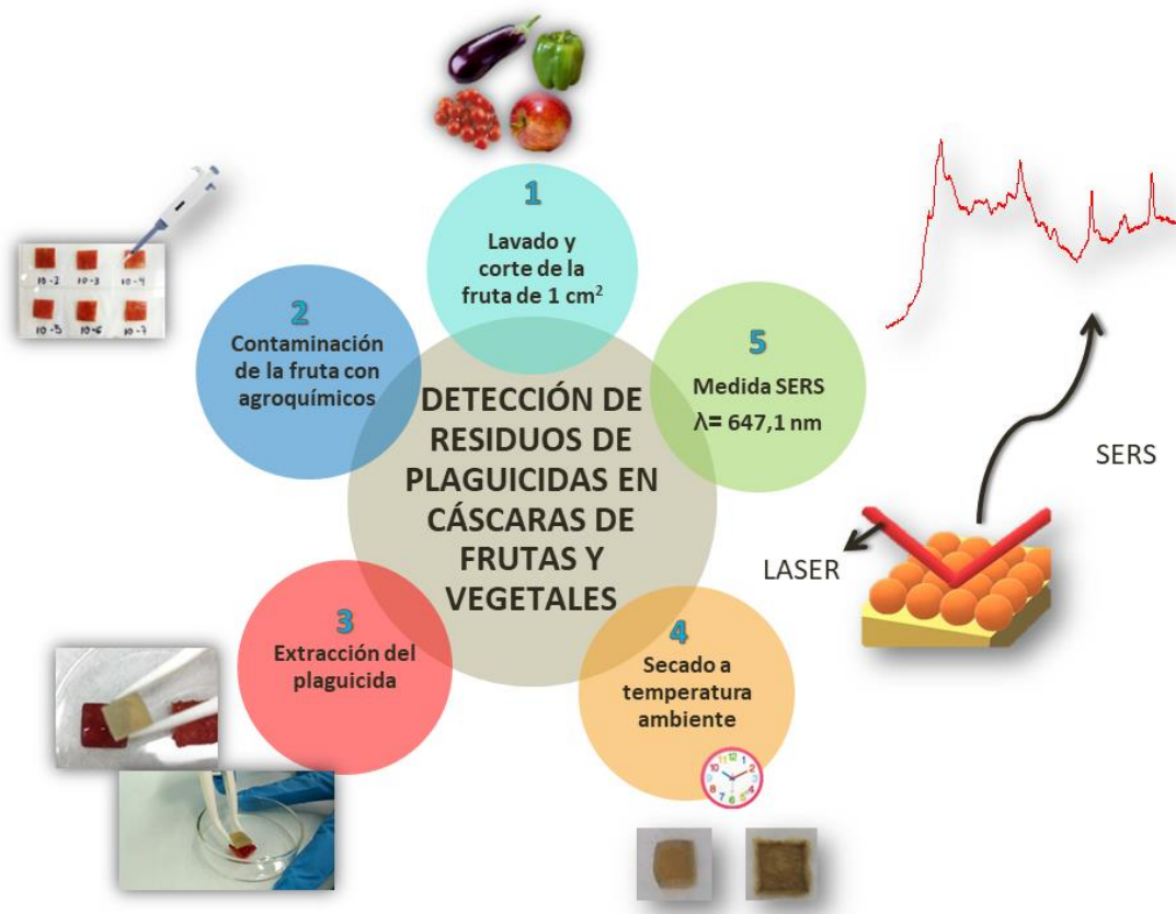
Figura 7.16.: Representación esquemática del proceso general de detección de plaguicidas sobre cáscaras de frutas y vegetales empleando la plataforma SERS de AgNPs inmovilizada en gel de agar.
