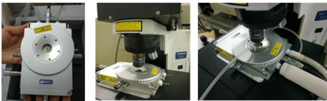
Figura 4.7.: Celda Linkam THMS600 acoplada al espectrómetro Raman con microscopio confocal.
