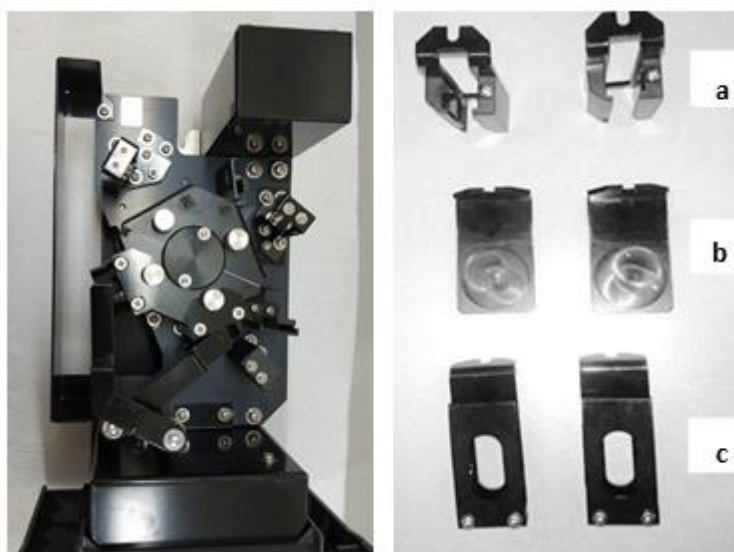
Figura 4.2.: Accesorio de espectrómetro UV-Vis de absorción Shimadzu UV-2600: esfera integradora modelo ISR-2600 para medir los espectros de reflectancia difusa (UV-Vis-DRS). Detalle del accesorio de esfera integradora. a) Portamuestras para celdas de cuarzo utilizadas para suspensiones líquidas. b) Portamuestras para pastillas de BaSO 4 utilizadas para muestras sólidas. c) Portamuestras para films.
