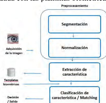
Fig. 1. Esquema de un sistema de reconocimiento biométrico de iris.
