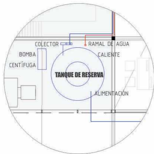
SALA DE MÁQUINAS PLANTA BAJA (TANQUE DE RESERVA)
