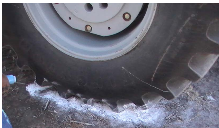
Figura 1: área de contacto rueda suelo marcada con talco.
