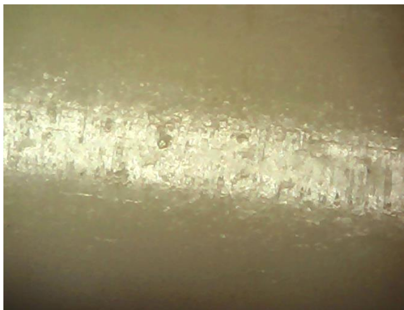
Superficie de PEEK con proteínas plasmáticas adheridas
