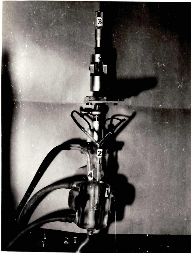
Figura 11: SOPORTE TISULAR, DISPOSITIVO MICROMETRICO Y BURBUJEADOR MONTADOS EN LA CAMARA TISULAR.
