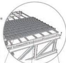
Panel E-KOVER Estructura secundaria Reticulado metalico
