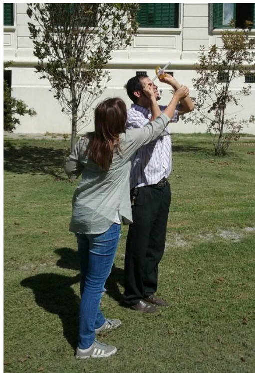
Figura 2: Uso del clinómetro, un operario realiza puntería y el otro lee el valor angular
