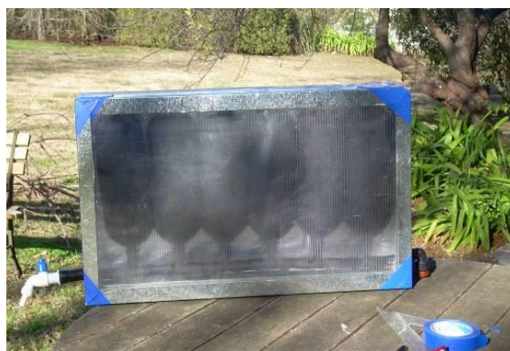
Fig. 4. Colector acumulador de botellas plásticas recicladas tipo valija. Suple las necesidades en casos de excesiva precariedad e inexistencia de tanques acumuladores de agua.
