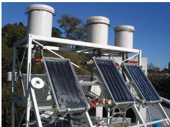
Fig. 3. Prototipo de colector comercial, prototipo de caños de PVC, y caños de polietileno.
