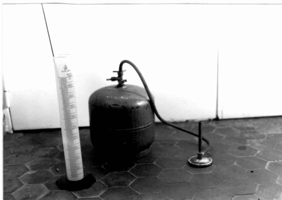
Nº 9 : Raspador, probeta y mechero a gas para el muestreo.
