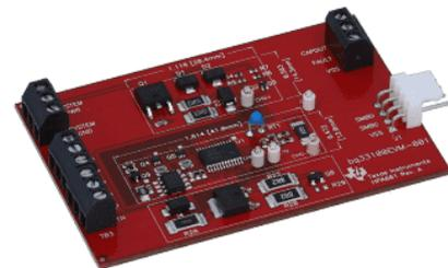
(b) Módulo de seguridad para hasta cinco celdas de SC (TIDA-00258).
