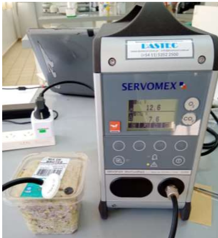
Figura 4.10 Medición de atmósfera dentro del envase
