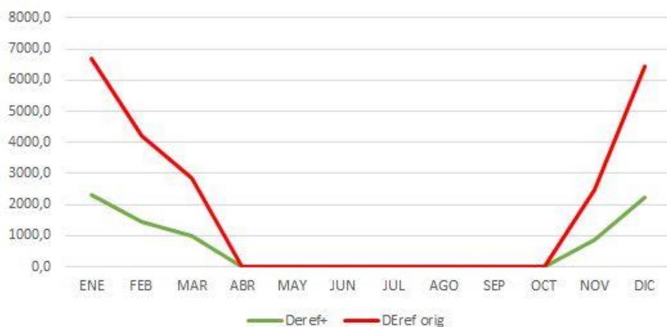
Figura 10: Comparación de la demanda de energía en refrigeración mensual del edificio original y mejorado. Situación verano.
