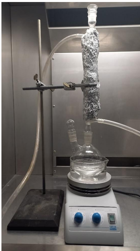
Figura 3-1. Equipo de preparación de catalizadores mediante activación ácida.
