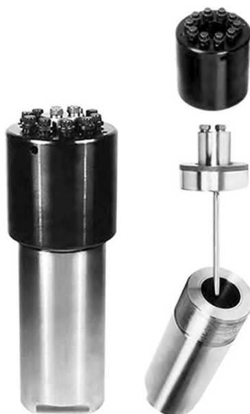
Figura 3-3. Reactor empleado para la esterificación de glicerol con ácido acético.
