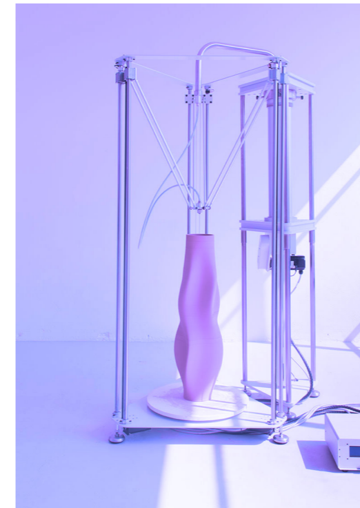
Impresora 3D de cerámica, realizada por Olivier Van Herpt.
