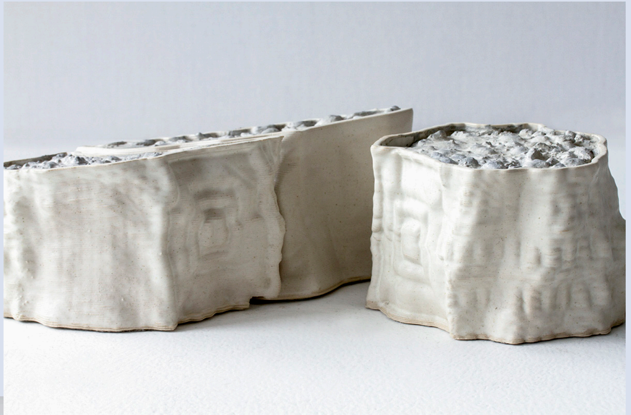
Figura 1 y 2. Ladrillos impresos 3D (2019), Polymorf
