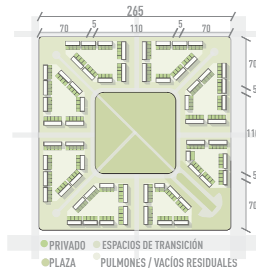
6 CLAUSTROS CONFORMAN UN SISTEMA EN TORNO A UNA PLAZA PRINCIPAL CENTRAL. 4 DE ESTOS SUBSISTEMAS ESTÁN CONFORMADOS POR 8 BLOQUES DE 4 O 5 VIVIENDAS UNIFAMILIARES C/U, CONTENIENDO UN TOTAL DE 34 UNIDADES FUNCIONALES EN TORNO A UN VACÍO DIVIDIDO EN PATIOS PRIVADOS Y VACÍO SIN USO APARENTE. LOS OTROS DOS CLAUSTROS PIERDEN UN BLOQUE Y MODIFICAN OTRO (TOTAL DE 28 UF), LIBERANDO Y JERARQUIZANDO 1 DE LAS ESQUINAS DEL SISTEMA.
