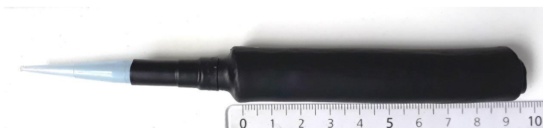
Figura 6.1: Columna armada C-Bent 500 ( 10 cm de largo efectivo por 2 cm de diámetro)
