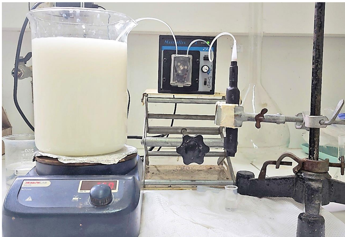
Figura 6.2: Sistema de adsorción en continuo.
