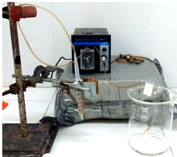
Figura AI.2: sistema de adsorción por columna en continuo utilizado.
