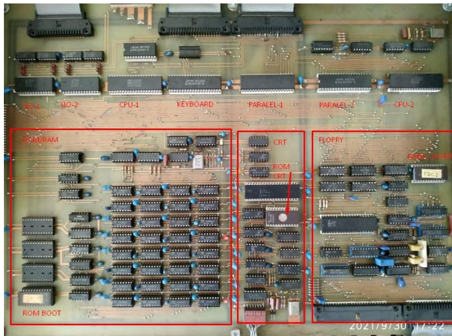
Figura 1. Sectores de la placa madre marcados por el propio Ing. Cammisa.
