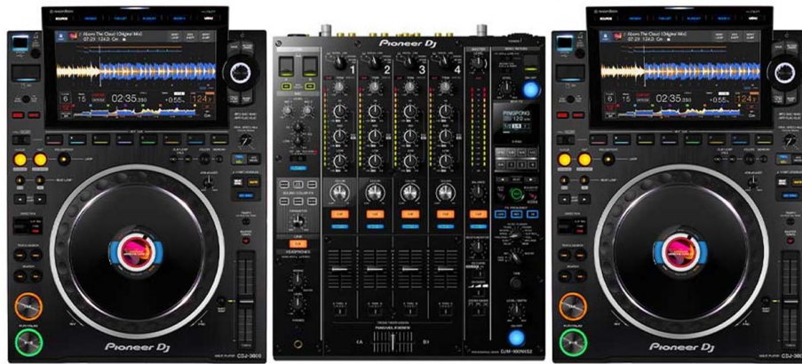
Figura 8. Dispositivos utilizados por el DJ para desarrollar su performance en una fiesta. Al medio, la mixer o mesa de mezcla; a los costados, las compacteras o CDJs.
