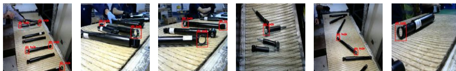
Fig. 1: Detección automática de faltante de bujes en línea de producción de amortiguadores.
