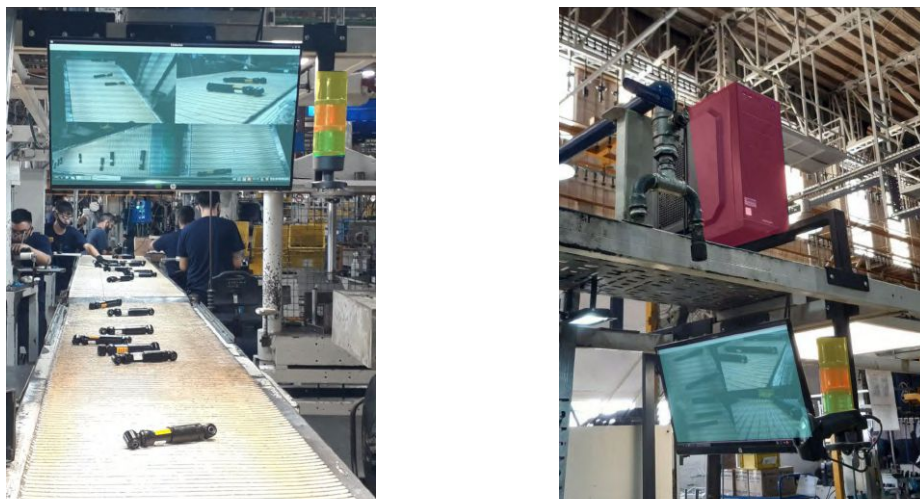
Fig. 6: Sistema de detección propuesto en condiciones normales de funcionamiento en la línea de montaje de la planta.
