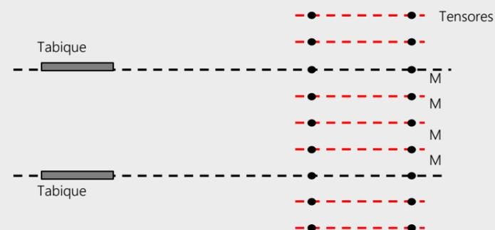
A partir de este modulo estructural, se empiezan a generar submódulos para los subsistemas restantes, como la envolvente, en donde se utiliza un modulo de 2m en el cual se colocan las carpinterías y los paneles metálicos que funcionan como protección solar.
