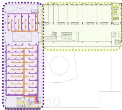
En cuanto a las instalaciones se realiza la misma sectorización pensando en los tiempos de uso del edificio y la orientación de los espacios. En este subsistema también se realiza una sectorización por nivel en las áreas de acceso público con el fin de ahorrar energía cuando solo se utiliza alguno de los espacios.
