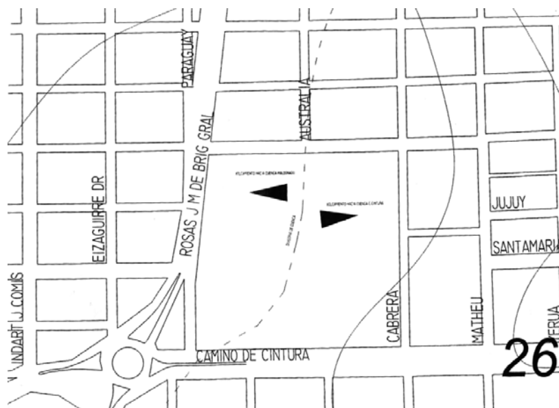
Figura 4.7. Plano de cotas de nivel y divisoria de cuencas en el solar.
