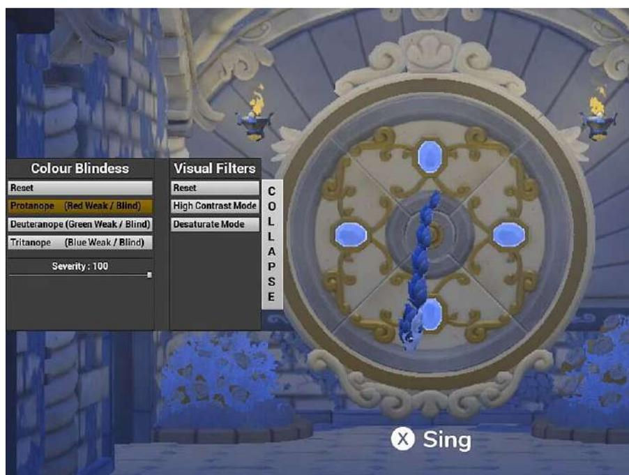
Figura 3.13 Herramienta de debug que permite simular diferentes tipos de daltonismo.
