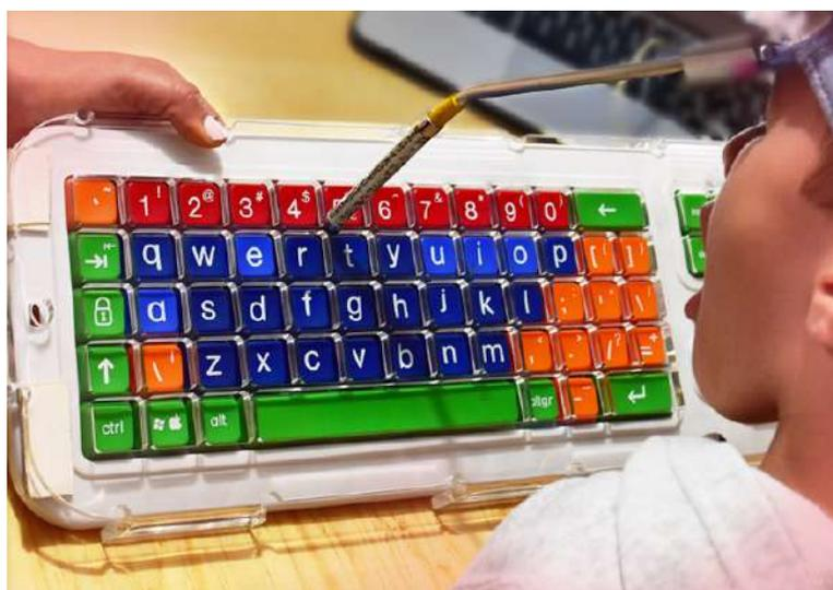
Figura 2.14 Un niño utiliza un puntero cefálico para interactuar con un teclado adaptado
