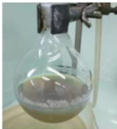
Figura 16: Crecimiento de AgNPs por calentamiento a reflujo de las semillas en presencia de citrato de sodio y nitrato de plata.
